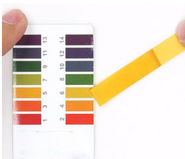
Рисунок 2. Измерение кислотности почвы с помощью лакмусовой бумаги
