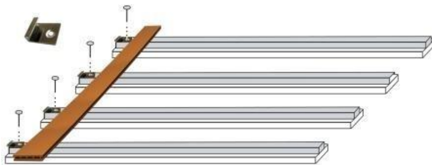
Рисунок 42 - Схема монтажа стартовой доски
