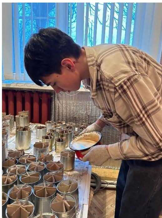
Процесс изготовления окопных свечей
