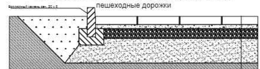
Конструкция плиточного покрытия (Тип 6,5,3) пешеходные дорожки
